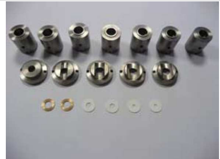
DE Adapter und Reduzerringe ermöglichen die Analyse von Proben geringer Größe oder dünnen Drähten
